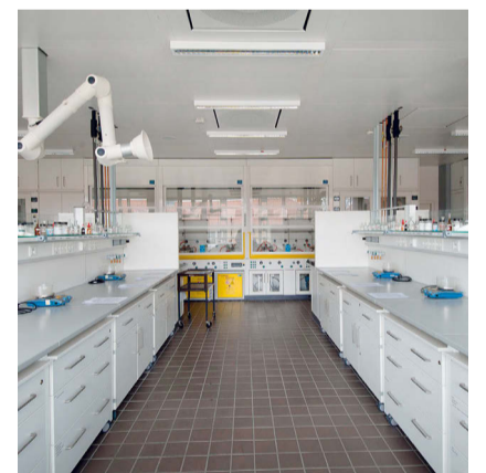
Vorher und nachher: Arbeitssicherheit und Umweltschutz sind in den sanierten Laboren (rechts) gewährleistet – glatte Oberflächen statt Fliesen, mehr und bessere Abzüge und keine Ausgüsse an den Arbeitsplätzen. FOTOS: UNIVERSITÄTSBAUAMT FREIBURG, SEBASTIAN WUNSCH
