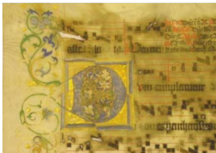
Tintenfraß in einer Musikhandschrift aus dem frühen 16. Jahrhundert: Noten- und Textverlust sowie Löcher im Pergament sind die Folge
