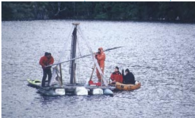
Eine selbstgebaute Bohrplattform ermöglicht Bohrarbeiten mitten im See.
