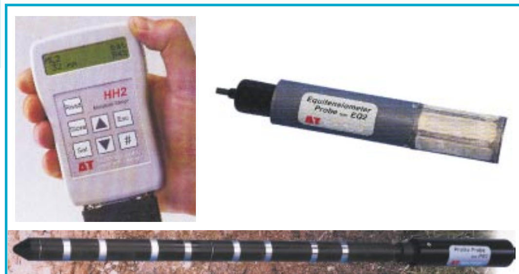
Beschäftigen zunehmend die Öffentlichkeit: Grundwasserqualität und Bodenbeschaffenheit. Hier Instrumente zur Vor-Ort-Messung von Saugspannung und Bodenfeuchte für verschiedenste Untersuchungsgebiete.
