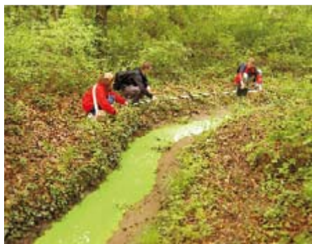
Untersuchung der Wechselwirkung zwischen Oberflächengewässer und Grundwasser mit dem fluoreszierenden Tracer Uranin
