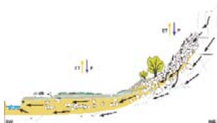
Konzeptvorstellung der Hangentwässerung abgeleitet aus experimentellen Prozessuntersuchungen
