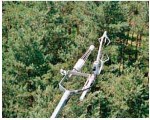
Mit einem Infrarot-Analyzer wird der CO<sub>2</sub>-Gehalt und mit einem Ultraschallanemometer die kleinen Turbulenzen bei Wind mit 20 Hz, also 20 mal pro Sekunde gemessen.
