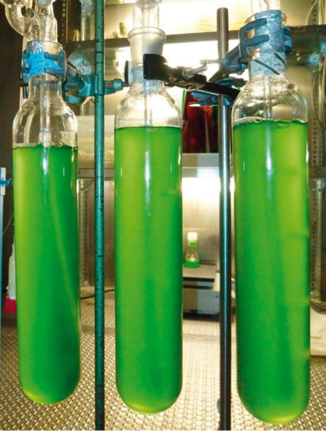
Ein-Liter-Reaktoren aus dem Labor: Forscher experimentieren mit Bakterienkulturen im kleinen Maßstab, um den Ethanolertrag zu steigern. Foto: Annegret Wilde
