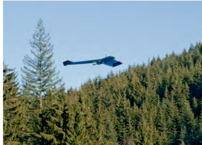
*Die unbemannte Flugplattform überfliegt in kurzer Zeit ein großes Gelände und ist mit einem Sensor ausgestattet, der entweder vorhandenes Sonnenlicht nutzt oder selbst elektromagnetische Energie erzeugt.*
